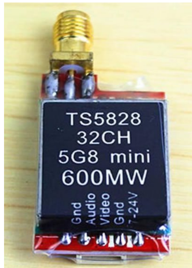
TS5828 5.8GHz 600mW 32 Channels Mini Wireless 2dbm A/V Transmitter
